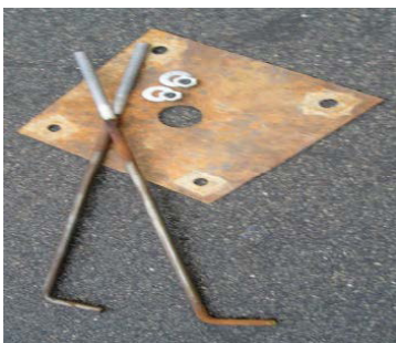
Fundamentbultar med brickor och muttrar samt gjutmall
